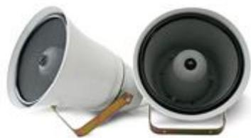
Громкоговоритель рупорный пылезащищенный 10ГР-38П ИЦ3.847.069 предназначен для оповещения и озвучивания открытых пространств в условиях повышенного шума, а также цехов и площадок с повышенным содержанием в атмосфере силикатной, угольной и ферромагнитной пыли и химически активных веществ.
