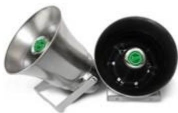
Громкоговоритель рупорный взрывозащищенный 25ГР-Д2В ТУ 6573-001-96875111-2007 предназначен для использования в качестве источника звука в системах производственно-технологической громкоговорящей связи, аварийного оповещения и озвучивания во взрывоопасных зонах всех классов кроме зоны О согласно ГОСТ Р51330.9-99 часть 10 и гл. 7.3 ПУЭ, где по условиям работы возможно образование взрывоопасных смесей, отнесенных к категориям IIA, IIB и группам Т1-Т6 по ГОСТ Р51330.11-99 часть 12.
