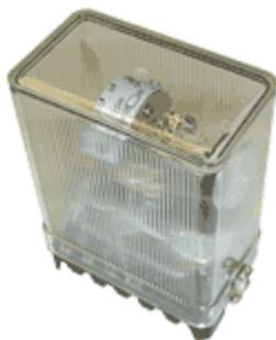
Реле **РН-55** применяется в схемах автоматического повторного включения для линий электропередачи с двухсторонним питанием в качестве органа, контролирующего наличие напряжения на линии и угол сдвига фаз между векторами напряжения на линии и на шинах станции или подстанции.
