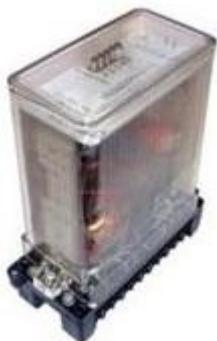
Реле (максимального) напряжения обратной последовательности с питанием от цепей напряжения постоянного тока вспомогательной воздействующей величины **РСН-13-1** предназначено для использования в схемах защиты в качестве органа, реагирующего на напряжение обратной последовательности при возникновении несимметричных коротких замыканий.
