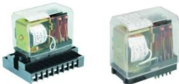
Реле РПУ-2М предназначены для работы в электрических цепях управления и промышленной автоматике переменного тока напряжением до 380 В частотой 50 Гц и постоянного тока напряжением до 220 В.
