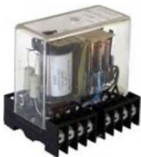
Реле промежуточное **РП-16-1М** предназначено для коммутации электрических нагрузок в цепях напряжением до 242 В постоянного и переменного тока частоты 50 и 60 Гц в схемах устройств релейной защиты, противоаварийной и системной автоматики электроэнергетических объектов, промышленной аппаратуре различного назначения и является комплектующим изделием.
