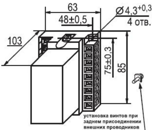
Присоединение внешних проводников - переднее либо заднее под зажимы с помощью винтов.
