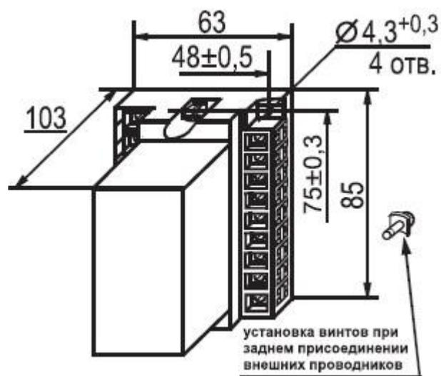
**При заказе необходимо указать:** тип реле, номинальное напряжение включающей и номинальный ток удерживающих обмоток, сочетание контактов, вид присоединения внешних проводников, рабочее положение реле «с поворотом» при установке с поворотом против часовой стрелки на  $90^\circ$ , климатическое исполнение.
