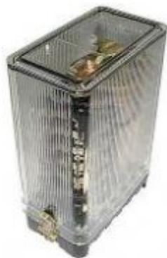
Реле промежуточное **РП-256** предназначено для использования в качестве вспомогательного реле в цепях переменного тока в тех случаях, когда коммутационная способность и количество контактов основных реле защиты недостаточны и требуется создание выдержки времени при снятии напряжения с обмотки реле.
