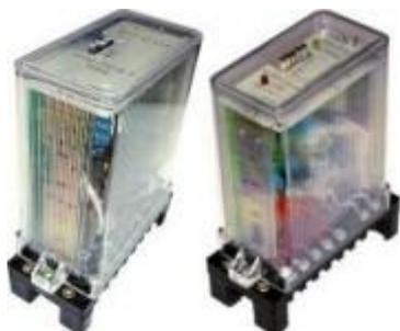
Реле РТЗ-51 и реле РТЗ-51.01 предназначены для использования совместно с трансформаторами тока нулевой последовательности в качестве органа, реагирующего на ток нулевой последовательности в схемах защит от замыканий на землю генераторов, двигателей и линий с малыми токами замыкания на землю и в других схемах устройств релейной защиты.
