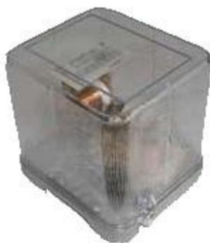
Реле тока мгновенного действия **РТ-40/Ф** применяется в схемах защиты установок переменного тока реагирующие на повышение тока, в тех случаях, когда требуется заглубление защиты при появлении высших гармоник тока.
