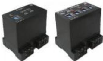
Реле статические тока РСТ-40-4 и РСТ-40-4В предназначены для применения в схемах релейной защиты и потивоаварийной автоматики энергосистем в цепях переменного тока частоты 50 Гц и являются комплектующими изделиями. Реле не требуют оперативного источника питания.
