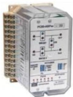
Микропроцессорные устройства автоматического ввода резерва АВР ( включения резервного питания) реле РС-80-АВРМ (РС-80-АВР) предназначены для использования в схемах АВР и релейной защиты и электроавтоматики понижающих подстанций и распределительных пунктов для выполнения автоматического включения резервного источника питания по сторонам 0,4-35 кВ.
