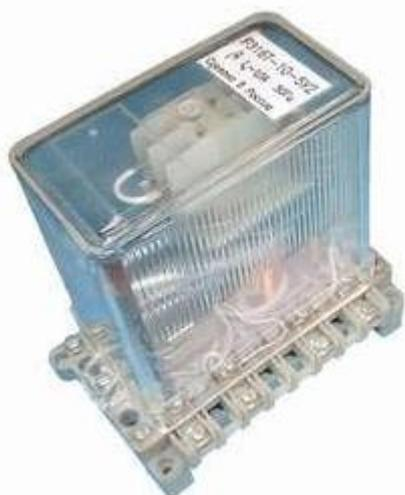
Реле минимального тока РЭ 16Т-10-5 является комплектующими изделиями и предназначены для применения в схемах НКУ электроприводов, в том числе в электрооборудовании электровозов для управления термоэлектрическим кондиционером.
