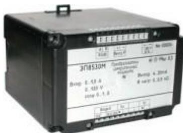
Преобразователи предназначены для линейного преобразования переменного тока (ЭП8554М) и напряжения переменного тока (ЭП8555М) в унифицированный выходной сигнал постоянного тока. Преобразователи могут применяться для контроля токов и напряжений электрических систем и установок и для автоматизации различных объектов энергетики и в других областях промышленности.
