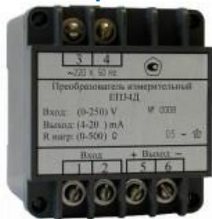
Преобразователи ЕПЗ4С, ЕПЗ4Д предназначены для линейного преобразования переменного тока и напряжения частотой 50Hz в электрических цепях с номинальным напряжением до 660V в унифицированный выходной сигнал постоянного тока. Преобразователи могут применяться для контроля токов и напряжений электрических систем и установок, для автоматизации различных объектов энергетики и в других областях промышленности.
