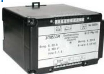
Измерительные преобразователи (далее - ИП) предназначены для линейного преобразования активной и реактивной мощности в трехфазных цепях в два гальванически развязанных между собой унифицированных выходных сигнала постоянного тока или линейного преобразования активной мощности в унифицированный выходной сигнал постоянного тока. ИП применяются в трехпроводных и четырехпроводных цепях переменного тока и предназначены для
