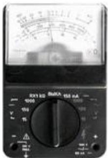
Группа многофункциональных приборов состоит из малогабаритных мультиметров, предназначенных для измерения силы и напряжения постоянного тока, действующего значения напряжения переменного тока и сопротивления постоянному току. Приборы могут использоваться при настройке и ремонте радио- и электробытовой аппаратуры.
