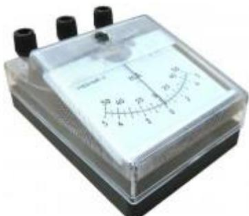
Приборы этой группы представлены отдельными амперметрами и вольтметрами типа "Учебный" и комплектом электроизмерительных приборов "Учебный-2". Используются в лабораториях школ, производственно-технических училищ, колледжей и других учебных заведений. Предназначены для измерения тока и напряжения в цепях постоянного и переменного тока частотой 50Hz.
