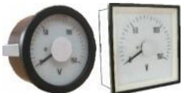
Приборы предназначены для измерения силы тока и напряжения в сетях переменного тока в однофазных цепях переменного тока частотой 50 Гц в различных областях промышленности и на железнодорожном транспорте. Приборы изготавливаются в пластмассовом корпусе и являются вибро- и ударопрочными. Во всех исполнениях предусмотрена подсветка циферблата.
