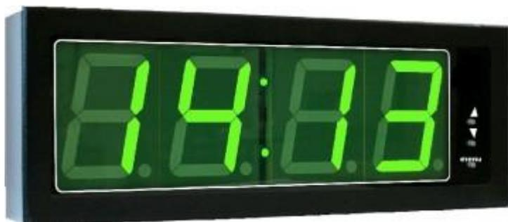
Табло-часы предназначены для отображения текущего времени и температуры (в зависимости от выбранного режима). Корректировка часов и минут осуществляется с помощью кнопок на лицевой панели табло, пульта дистанционного управления типа RC -5. Крепеж табло осуществляется навесным способом.
