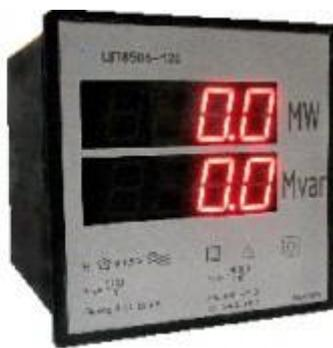
Прибор предназначен для измерения активной, реактивной, активной и реактивной мощности трехфазных трехпроводных цепей переменного тока частотой от 45 до 55Гц, отображения текущего значения измеряемой мощности на цифровом индикаторе и преобразования его в аналоговый выходной сигнал. По заказу приборы могут изготавливаться с интерфейсом RS485.
