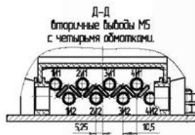
Схема принципиальная с четырьмя вторичными обмотками
