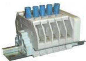
Блок зажимов наборных серии БЗН24 предназначен для присоединения и ответвления медных и алюминиевых проводников в электрических цепях переменного тока напряжением от 6 до 660 В частоты 50 Гц и 60 Гц и постоянного тока напряжением от 6 до 440 В и применяется как комплектующее изделие в стационарных установках.
