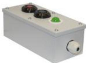
Посты управления кнопочные серии ПКУ предназначены для дистанционного управления электромагнитными аппаратами в электрических цепях управления переменного тока до 500 В частотой 50 и 60 Гц и постоянного тока напряжением до 220 В стационарных установок.
