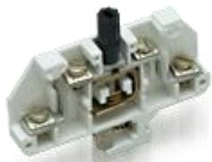
Зажим наборный серии ЗН24 предназначен для присоединения и ответвления медных и алюминиевых проводников в электрических цепях переменного тока напряжением от 6 до 660 В частоты 50 Гц и 60 Гц и постоянного тока напряжением от 6 до 440 В и применяется как комплектующее изделие в стационарных установках.
