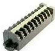
Блок зажимов серии БЗ24 предназначен для присоединения и ответвления медных и алюминиевых проводников в электрических цепях переменного тока напряжением от 6 до 660 В частоты 50 Гц и 60 Гц и постоянного тока напряжением от 6 до 440 В и применяется как комплектующее изделие в стационарных установках.
