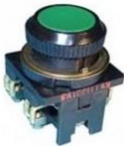
Выключатель КУ предназначен для дистанционного управления электромагнитными аппаратами в электрических цепях управления переменного тока до 500 В частотой 50 и 60 Гц и постоянного тока напряжением до 220 В стационарных установок.
