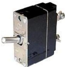
**Автомат защиты сети серии АЗС** предназначен для автоматического отключения потребителей электроэнергии при перегрузках и коротких замыканиях в цепях постоянного тока при напряжении до 30 В в закрытых стационарных и передвижных установках. Автоматы защиты сети классифицируются по номинальному току.
